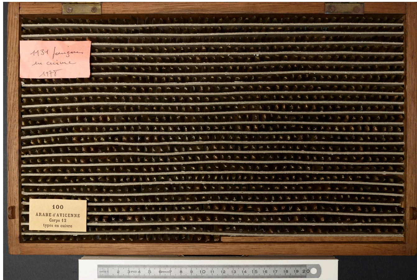
Fig. 1a : Poinçons de l'arabe d'Avicenne qui ont permis de composer le texte en persan du Cantique des oiseaux.
